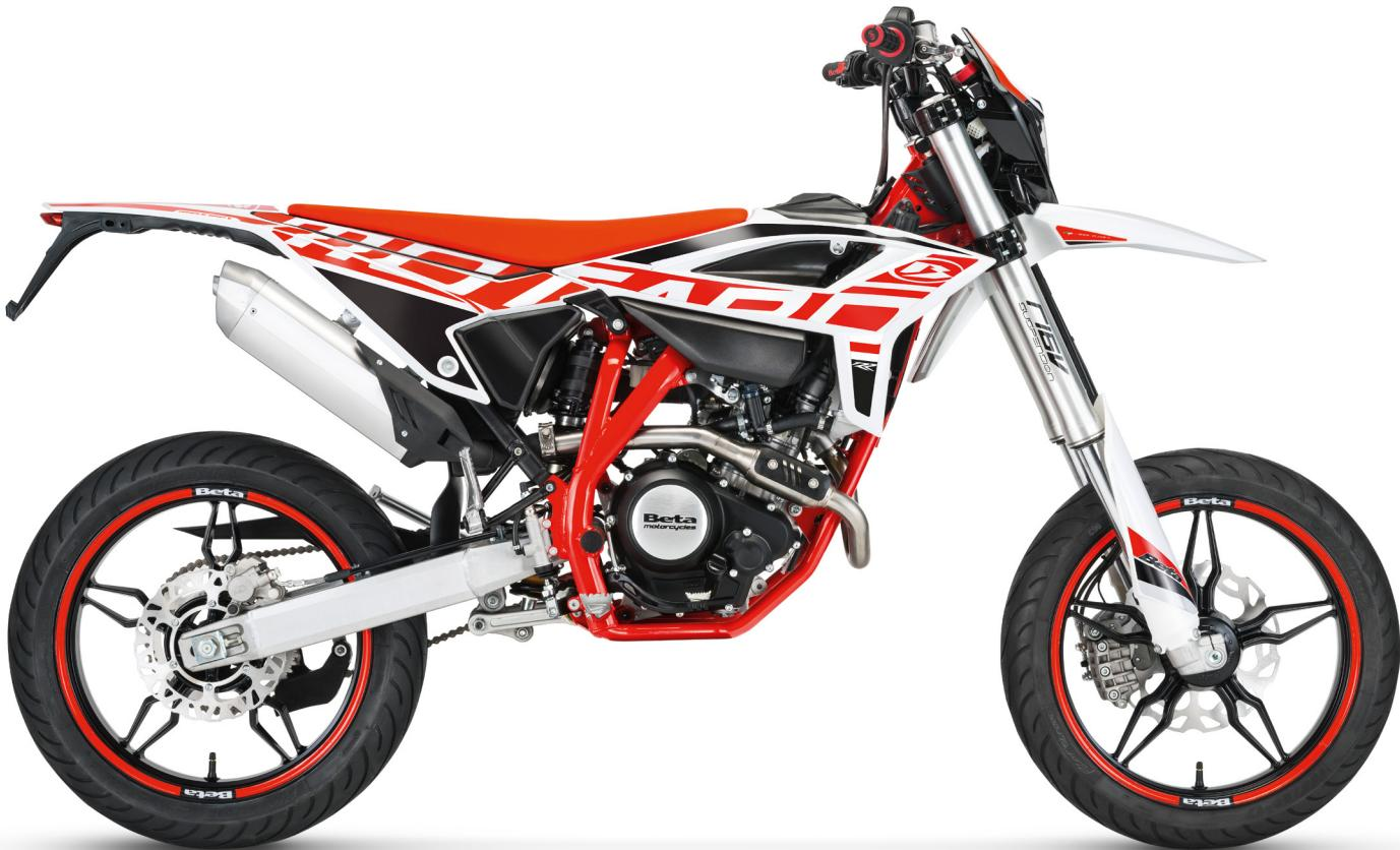
**Nuovo motore 125 4T EFI Euro 5, dotato di VCT e frizione antisaltellamento.** / New engine 125 4T EFI Euro 5, equipped with VCT and slipper clutch. / Nouveau moteur 125 4T injection électronique Euro 5 équipé avec arbre à cames à avance variable des soupapes et embrayage anti dribbling. / Neuer motor 125 4T EFI Euro 5, Mit variablen Steuerzeiten und Antihopping-Kupplung.
